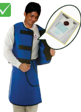
TLD below apron
